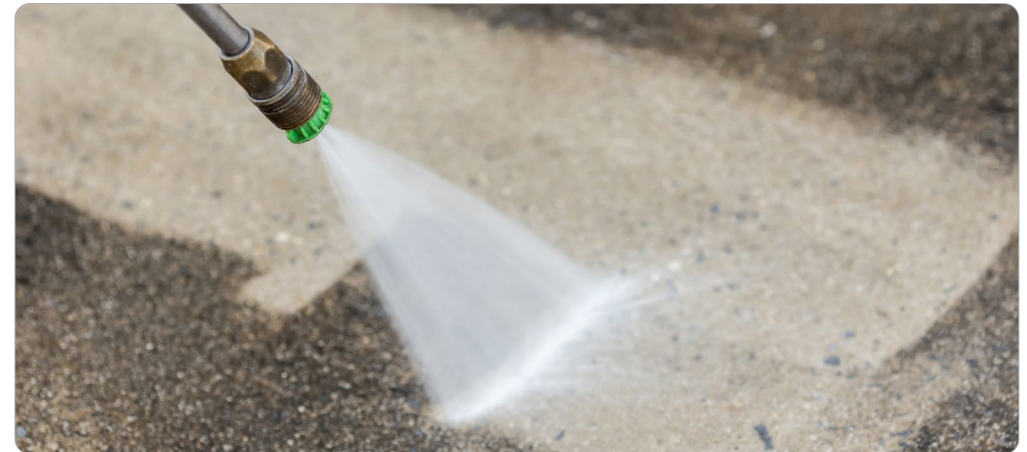
Düse eines Hochdruckreinigers aus dem Werkstoff 440C
