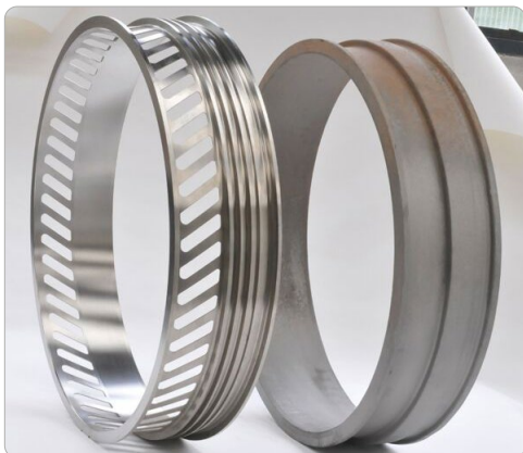
Fahrwerksteile aus den Werkstoffen EN 1.4548 (17-4PH), umgeschmolzen, und EN 1.4545 (AMS 5659, ASTM 564) (Foto: Iconos)
