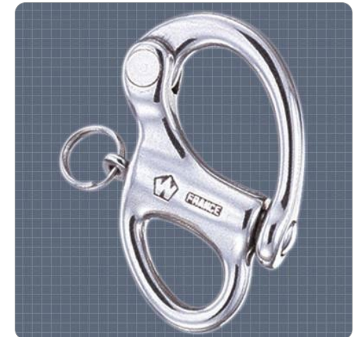
Schiffsausrüstung - hochfester geschmiedeter Schnappschäkel mit festem Auge aus Werkstoff EN 1.4542 (AISI 630) (Foto: Wichard SA, Frankreich)
